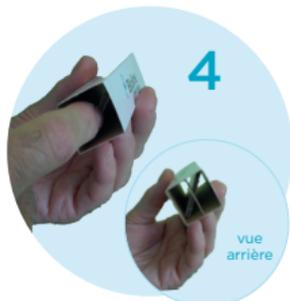
Pousser le diffuseur jusqu'au contact avec la butée arrière
